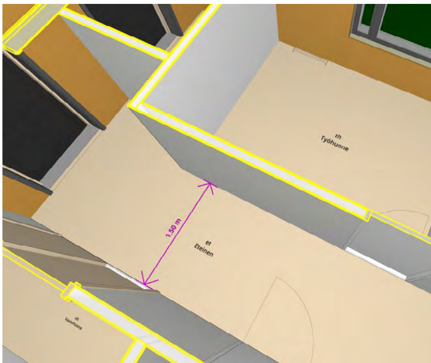
Kuva 4. Esimerkki mittaustyökalun hyödyntämisestä rakennuksen tietomallin tarkastelussa Solibri-ohjelmistolla.
