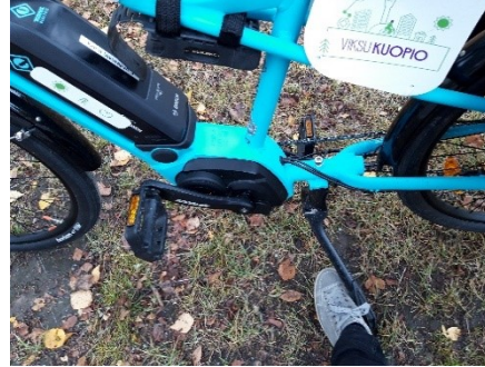
Seisontatueltä poisotto: pidä jalkaa seisontatuen edessä ja työnnä pyörää eteenpäin
