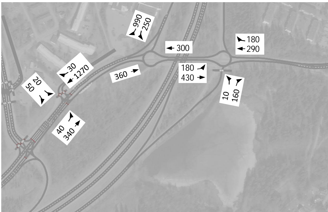
AHT 2035, liikennevirrat (ajon. / aht). Vuonna 2023 valmistuneen vt 5 MasterPlan työn aikana määritellyt liikennemäärät.
