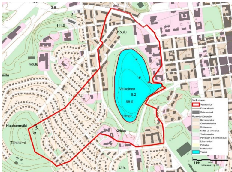
Kuva 1. Valkeisen valuma-alue ja maankäyttö
