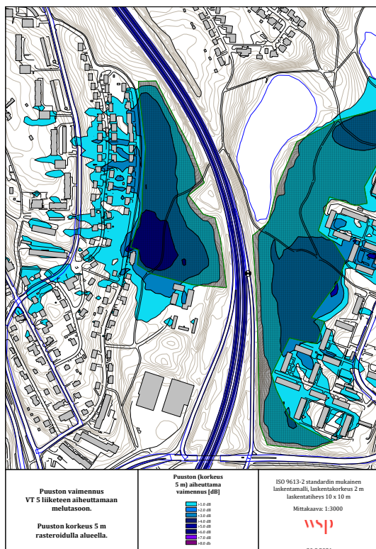
Kuvat 5 – 7. Puuston aikaan saamat vaimennukset tieliikenteen aiheuttamaan melutasoon Rahusenkaan ja Peipposenrinteen alueilla: vas. yläkulma: 20 m korkean puuston vaikutus, oikea yläkulma: 10 m korkean puusto vaikutus, vasen alakulma: 5 m korkean puuston vaikutus.
