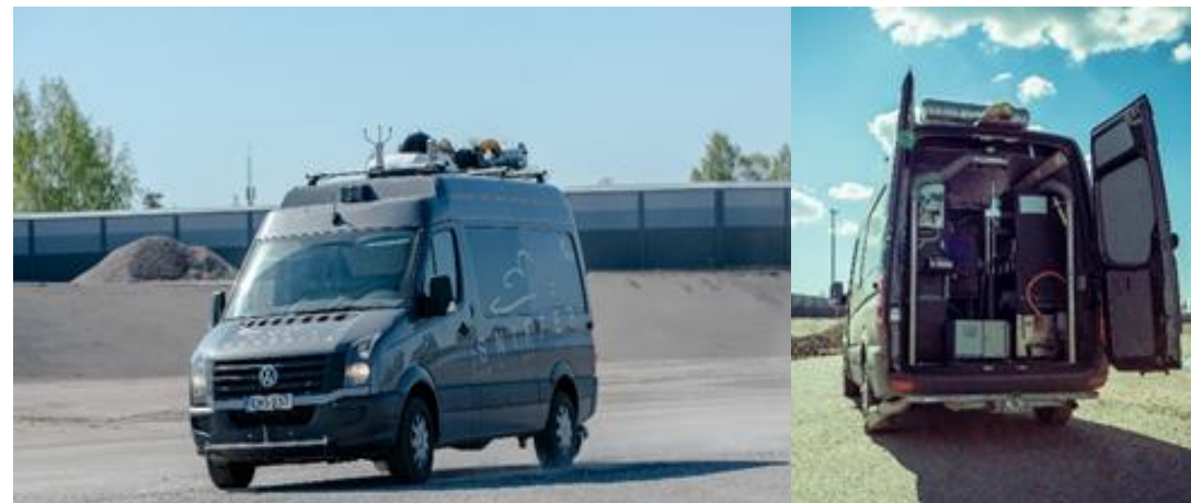
Kuva 17. Katupintojen pölyisyyden mittaukseen käytettävä Nuuskija-auto.
